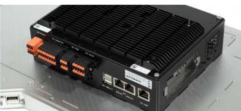
Die A2-PAC Basiseinheit ist neben der Standalone-Variante für die Schaltschrankmontage auch als Systemeinheit für L1/C1 Panels verfügbar. In dieser Kombination kann der A2-PAC als Touch-PLC eingesetzt werden. Die xA-Systemeinheit wird dazu einfach auf der Rückseite des Panels montiert. Display, Touch, USB und Spannungsversorgung werden über die standardisierte mechanische und elektrische Schnittstelle geführt.
